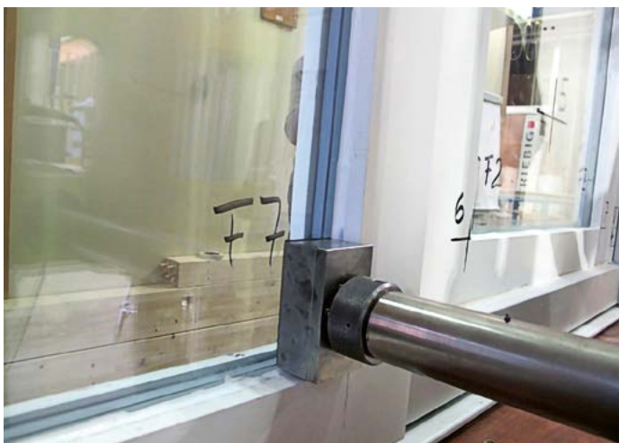
Abb. 11: Prüfstempel bei der statischen Prüfung einer transparenten Füllung.
