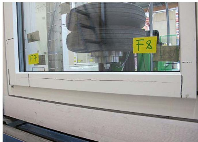
Abb. 12: Stosskörper von 50 kg Gewicht für die dynamische Prüfung.
